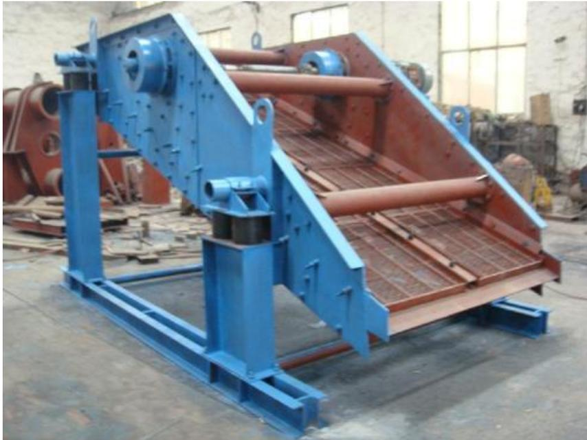
振动筛操作检查：设备在出厂前需精工征集装配及无负载试车，经检查各项指标合格后方可出厂，因此，设备在发运到使用现场后，用户应按装箱清单及成套设备发货单检查整台机器的零部件是否齐全，技术文件有否纰漏。设备到达现场后，不可直接搁置在地面上，应平稳放置在平整的枕木上，并要求离地面距离不小于250mm。如果存放在露天，应加防油布遮盖，以防风雨侵蚀。
