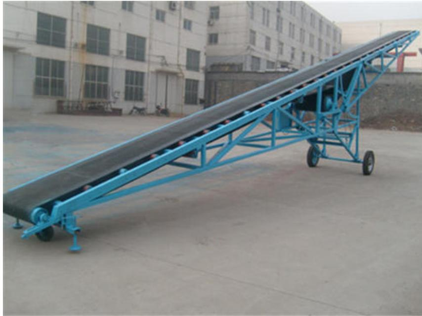
电动滚筒的工作原理： 电动滚筒带动皮带进行运转，绕经运输机全长的封闭皮带，由机头传动电动滚筒带动皮带在皮带架上连续运行，将输送皮带上面的煤炭运送到机头，转入其他运输设备中，并最终将物料运输到计量仓内，从而实现煤炭的连续性运输。左右法兰轴及驱动电机外壳联结成连续的抗弯梁，承受胶带的拉力，电动机经两级齿轮减速后，带动滚筒体旋转。在滚筒转动时，焊接在滚筒内壁上的刮油板带起注入滚筒内的机油，从而实现对电机、齿轮、轴承等零部件的冷却和润滑。
